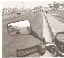
Espelho esférico convexo (exemplo: espelho retrovisor de motocicleta).
